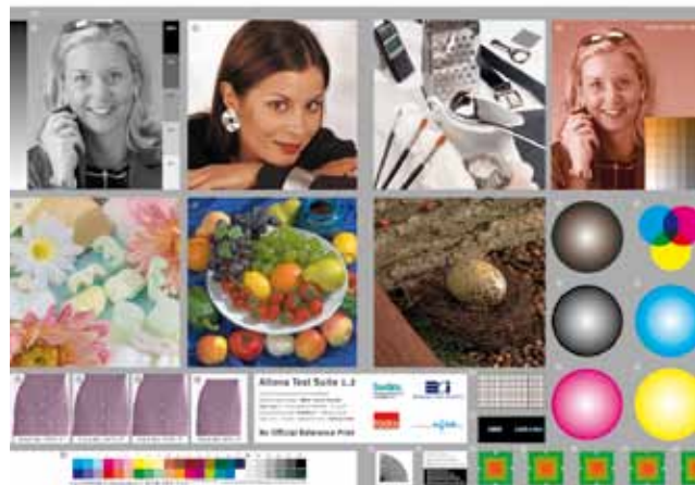
Im Rahmen der PSO-Zertifizierung werden Bildschirme, Proofgeräte, CtP-Belichter und Druckmaschinen mittels standardisierter Testformen kalibriert (z.B. Altana Test Suite).
